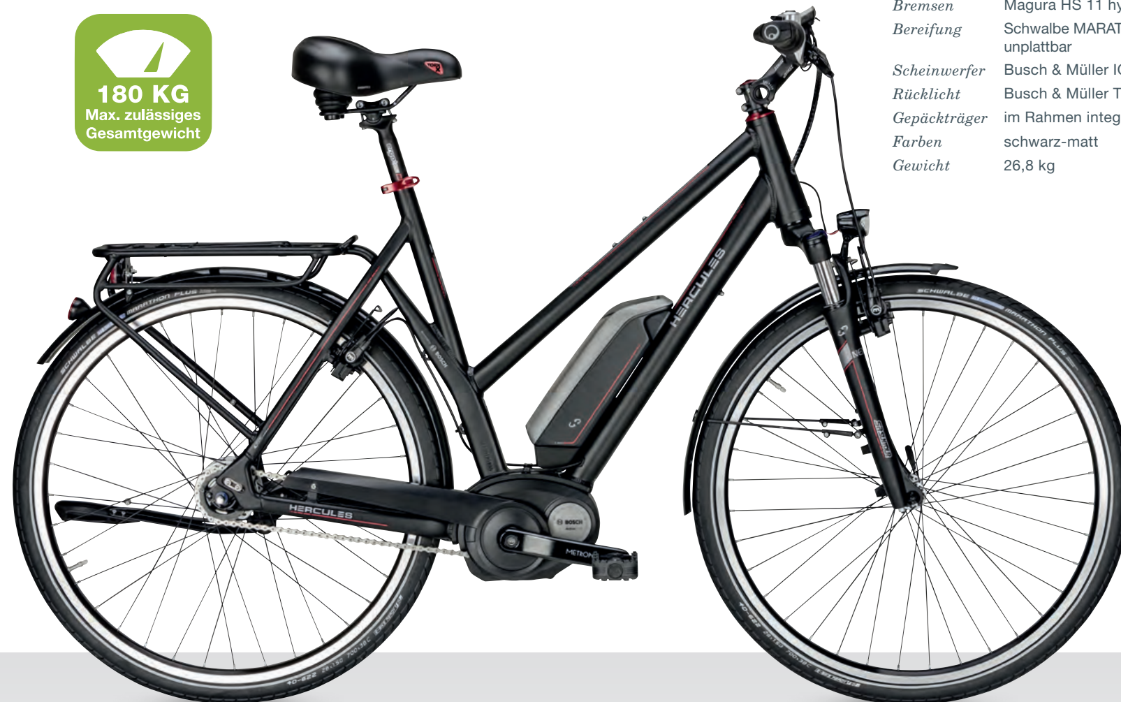
Zentralrohr 28 Zoll RH 46|50|55|60 cm 26 Zoll RH 43 cm
